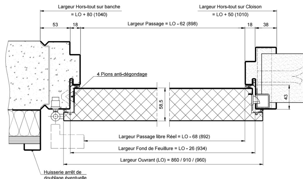
MPE47 : Installation de l'huissierie métallique sur murs béton ou parpaings de 100 mm d'épaisseur minimum (cf. [fiche technique MME-090](#))
