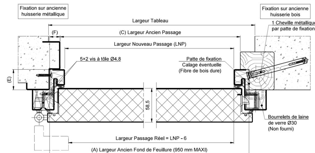
MPER47 : Installation du bâti sur-mesure sur huissierie métallique ou bois existante Bourrage par bourrelets de laine de verre diamètre 30 mm obligatoire (cf. [fiche technique MME-096](#))
