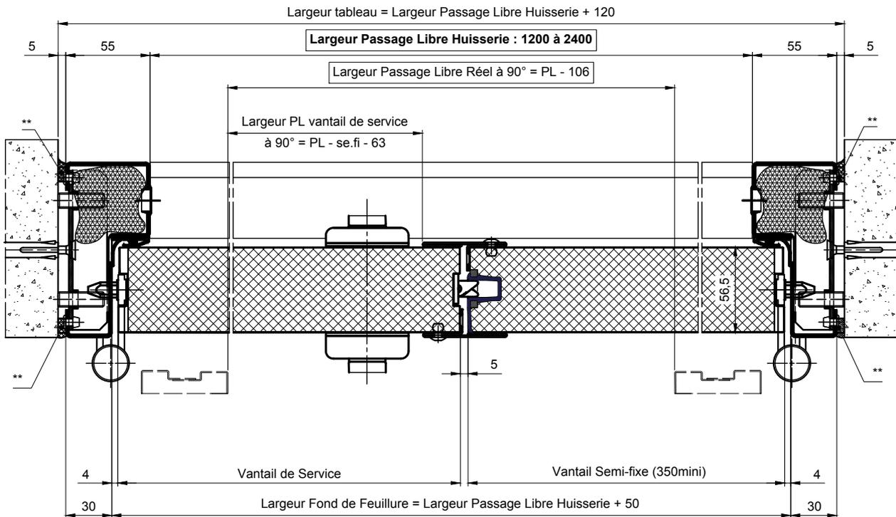
\*\* : Mastic d'étanchéité sur fond de joint
